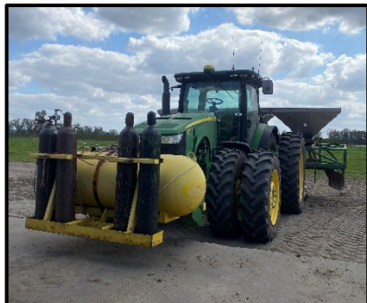
Sistema cerrado para aplicación de TELONE™ con un tanque contenedor y cilindros para mantener el fumigante y sistema de presión de nitrógeno.
