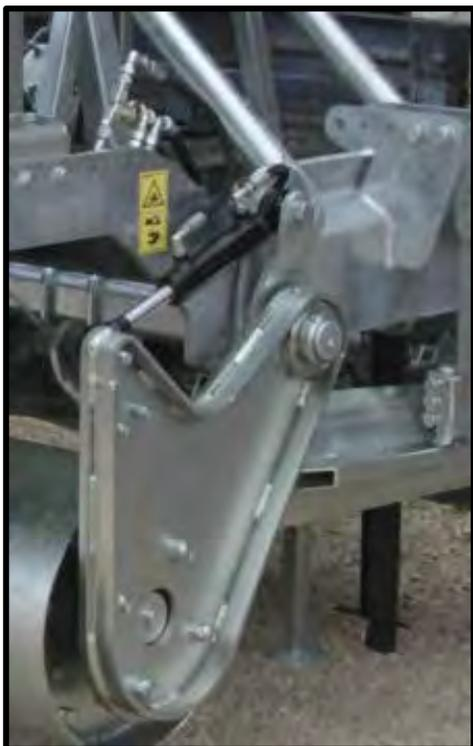
Regolazione idraulica della profondità di lavoro della macchina. Con comando in cabina.
