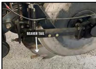
Una piccola lama d'acciaio chiamata "coda di castoro" è montata appena sopra il punto di iniezione. Questa chiude le tracce del coltello sotto il suolo superficie.
